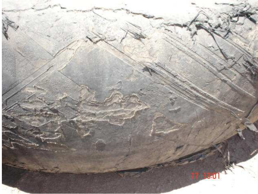
Figura 5.2: Neumático con Mallas de Nylon.
