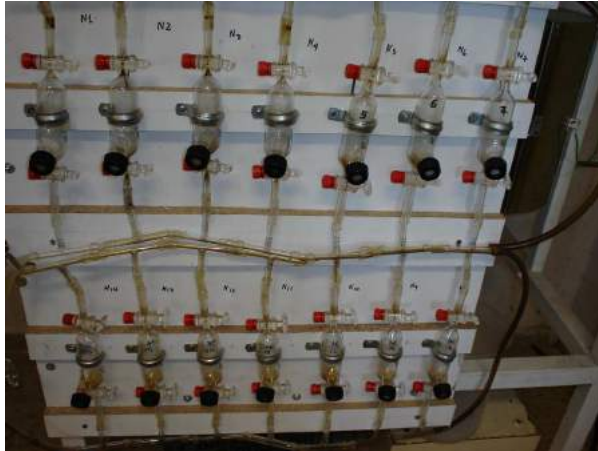
Figura 5.5. Toma de muestras gaseosas
